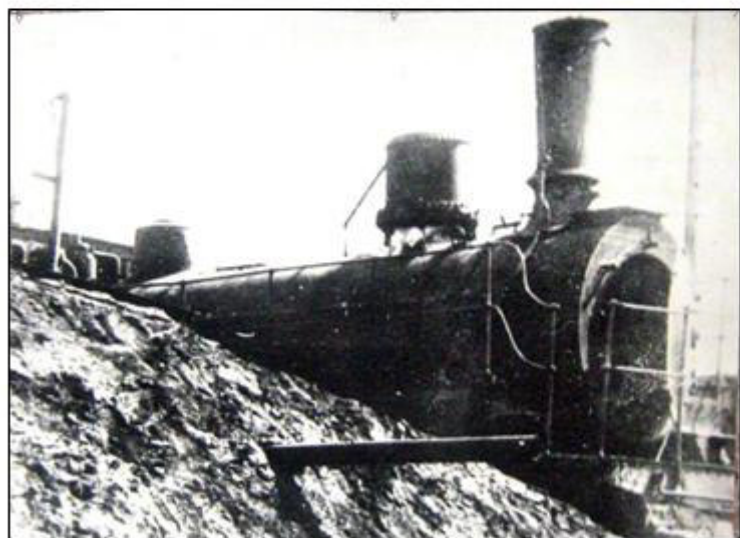
Паровоз, вырабатывающий электроэнергию для работы станков на котельном заводе. Фото 1943 г. из фонда музея школы № 31.
